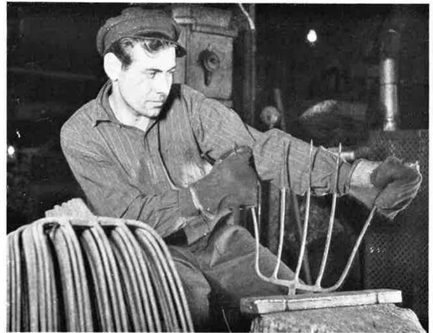
Wedevågs Bruks Handredskapsfabrik. Kontrollprov av grepens seghet genom isärdragning av klorna. Wedevåg Works Agricultural Implements Factory. Tenacity-test.
