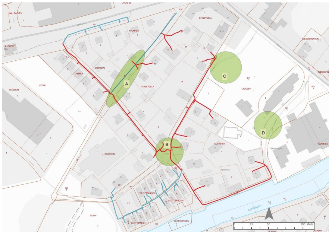
Figur 7 Den faktiska, inmätta schaktlängden markerad med blå färg, och den därav övervakade sträckan markerad med röd färg
