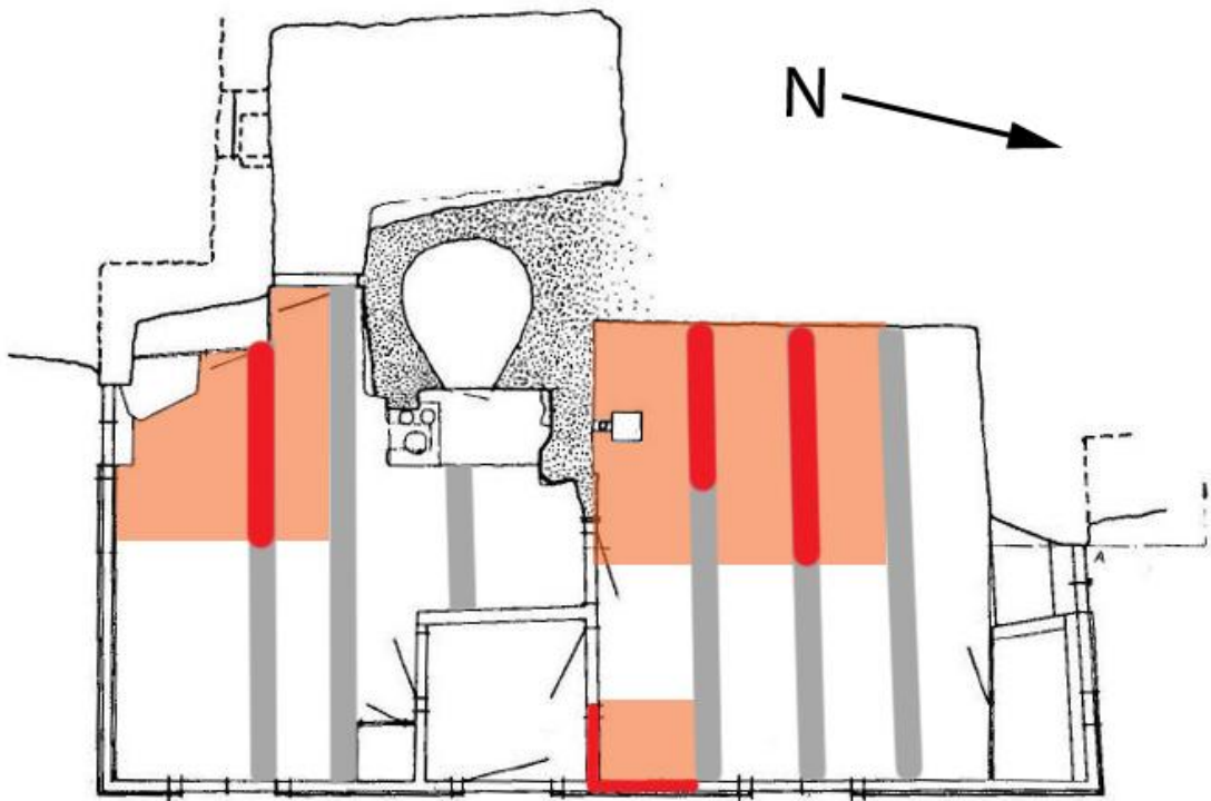
Fig. 7. Röttskadade partier av innertaket. Rött markerar timmer och orange takbrädor.
