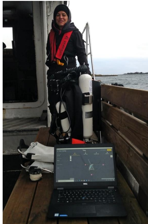
Figur 4 UWIS akustiska basnavigeringssystem (v) och dränkbar surfplatta och dyk- navigationsdiagram visas på bärbar dator (h). Foto: B. Foley.
