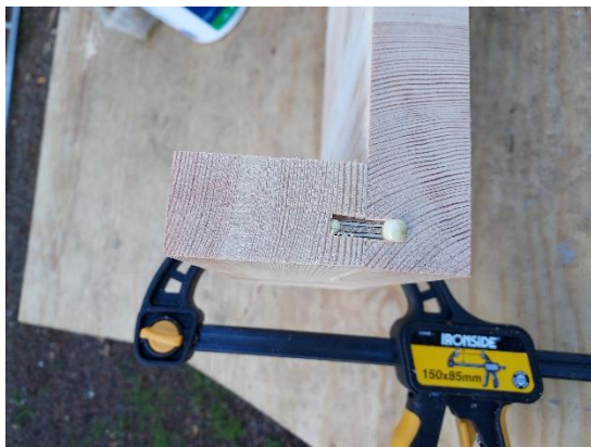
Fig. 16. Hopmontering av pilasterbas.
